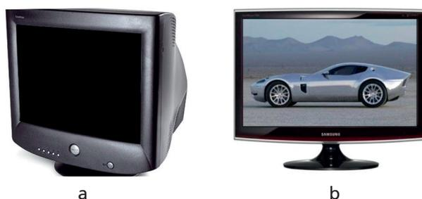
**Fig.1.36** Monitores: a) CRT; b) LCD
