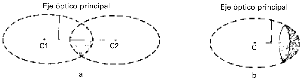
Fig. 7.6 Esfera a la que pertenecen las superficies de: a) una lente, b) un espejo.
