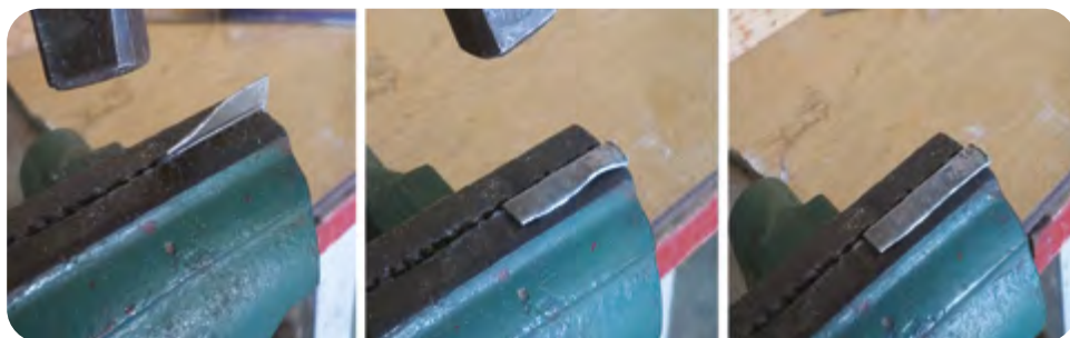
Fig. 2.46. Secuencia del doblado inicial para formar la pestaña
