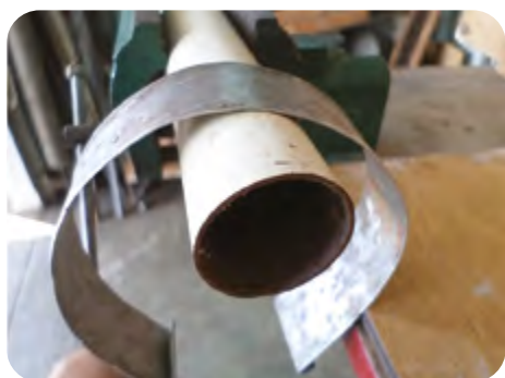
Fig. 2.48. Ajuste de la lámina a su forma definitiva
