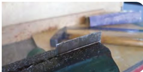
Fijación en el tornillo de banco para el doblez
