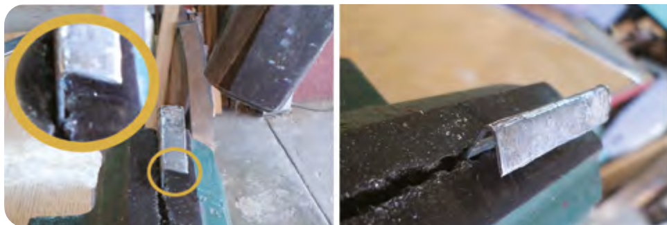
Fig. 2.47. Continuación del doblez inicial para garantizar la unión por pestañas
