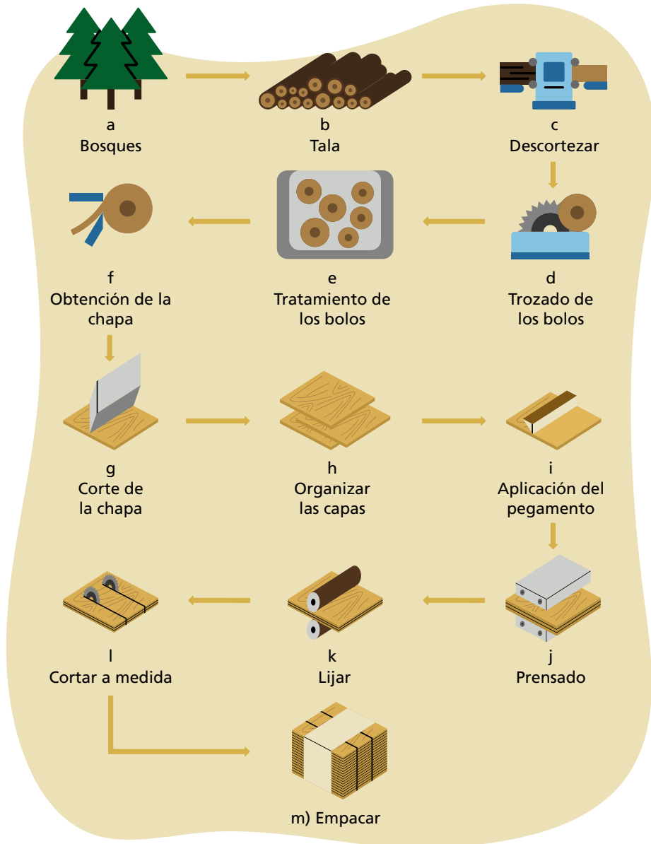
Fig. 2.15. Proceso de obtención de la madera contrachapada
