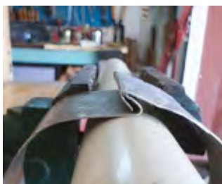
Utilización de pieza circular y el tornillo de banco para iniciar el golpeo
