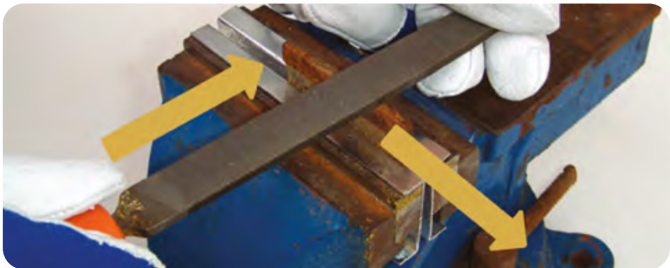
Fig. 2.39. Limado de láminas finas de metal
