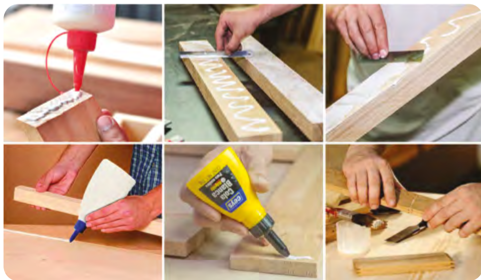
Fig. 2.28. Aplicación de cola de acetato
