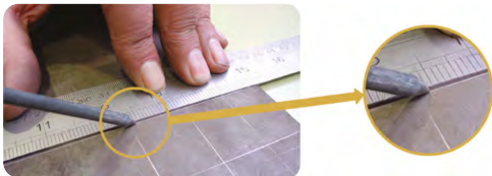
Fig. 2.34. Trazado con la punta de trazar
