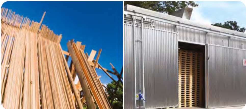
Fig. 2.13. Secado de la madera. a. Natural. b. Artificial
