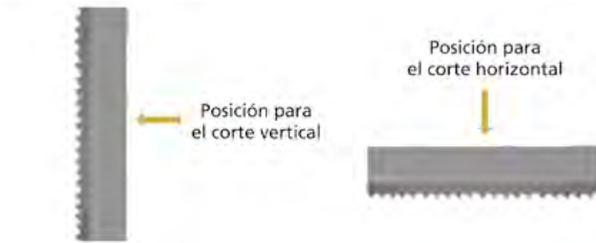
Fig. 2.24. Posición de la hoja según el tipo de corte
