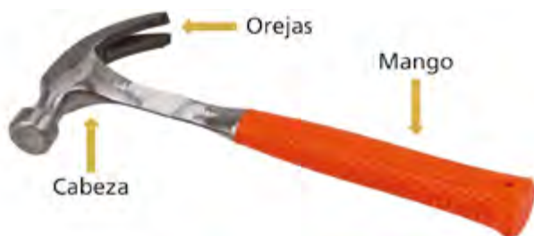
Fig. 2.27. Martillo de orejas y sus partes
