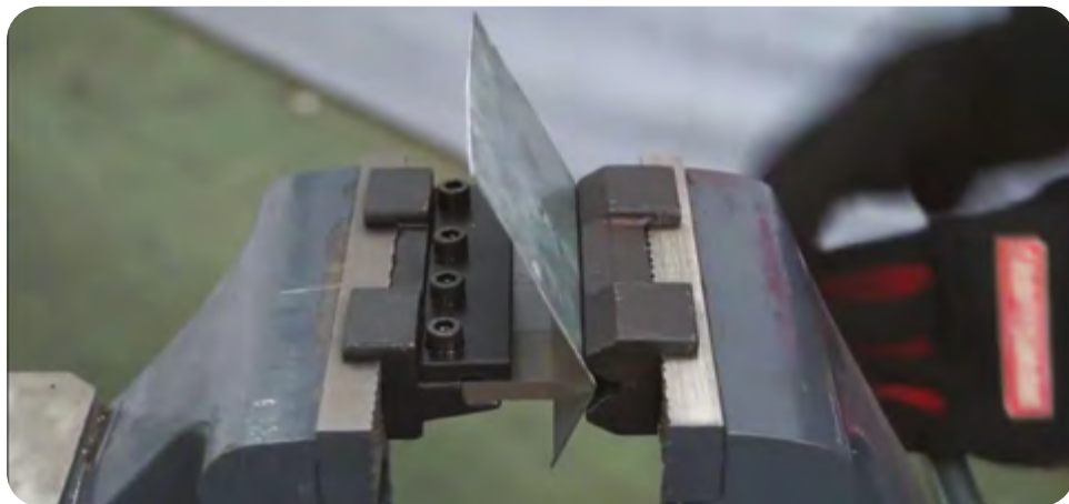
Fig. 2.40. Doblado del metal en el tornillo de banco
