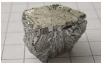
Fig. 3.34 Muestra del metal bario, Ba(s)
