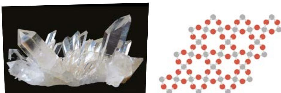
Fig. 3.7 Muestra de dióxido de silicio en forma de cuarzo y representación de su red cristalina
