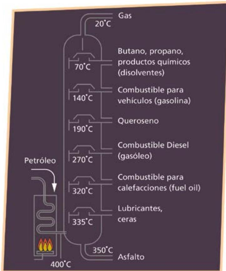
Fig. 1.40 Destilación fraccionada del petróleo
