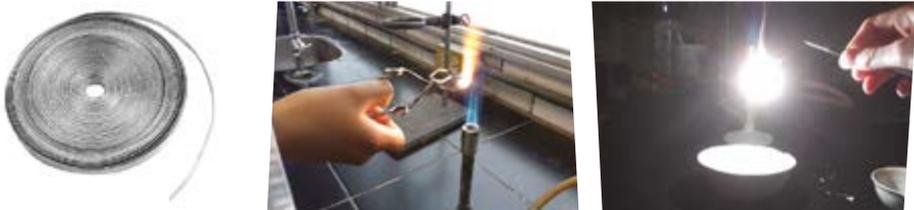
Fig. 2.39 Reacción química del dioxígeno con el magnesio
