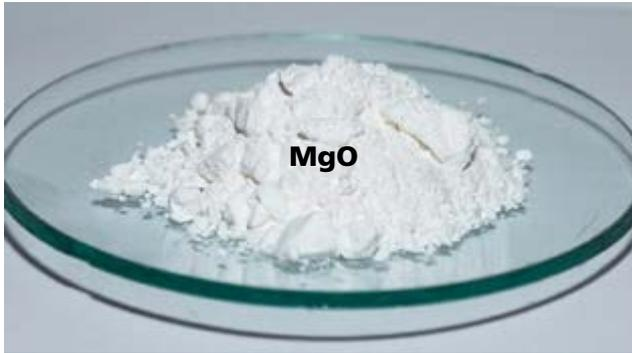
Fig. 3.21 Una muestra de óxido de magnesio, MgO
