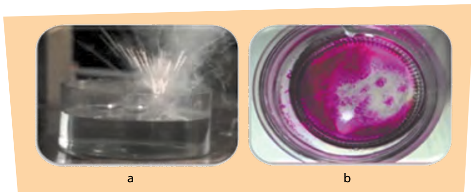
Fig. 2.14 Reacción química del metal sodio con el agua (a) y su cambio de color al intervenir la fenolftaleína incolora (b)
