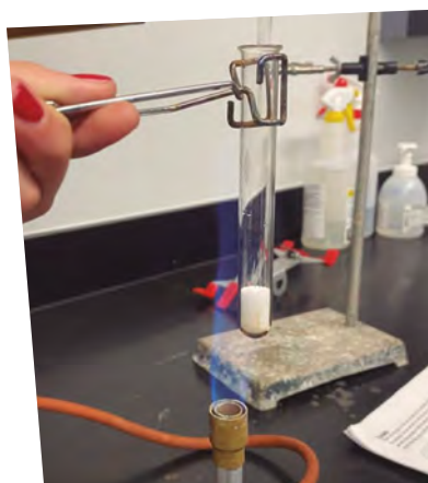
Fig. 1.49 Descomposición térmica de la piedra caliza
