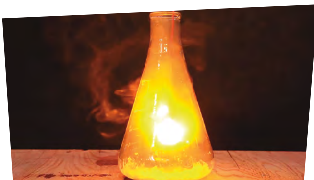
Fig. 1.22 Violenta reacción química del metal sodio con el dicloro gaseoso
