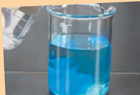
Fig. 2.15 Formación de un precipitado de hidróxido de cobre (II) [Cu(OH)_2(s)] , a partir de disoluciones acuosas de hidróxido de potasio [KOH(ac)] y sulfato de cobre (II) [CuSO_4(ac)]
