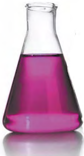
Fig. 2.8 Coloración que toma el indicador fenolftaleína frente a las disoluciones acuosas de hidróxidos metálicos
