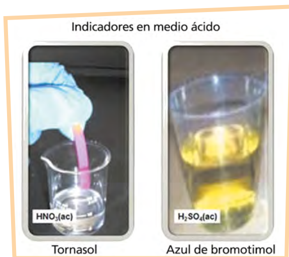
Fig. 2.27 Coloración que toman los indicadores tornasol y azul de bromotimol en disoluciones acuosas de ácido nítrico y de ácido sulfúrico, respectivamente
