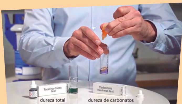
Fig. 1.29 Diferentes métodos para determinar la dureza del agua en el laboratorio y la industria
