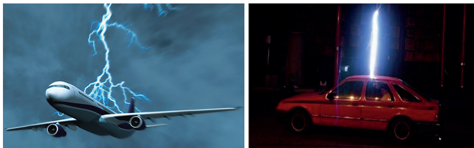
Fig. 3.61 A pesar de la enorme energía involucrada en el proceso de una descarga atmosférica que impacte sobre un automóvil o avión, en el interior de estos el campo eléctrico es nulo y sus ocupantes estarán protegidos
