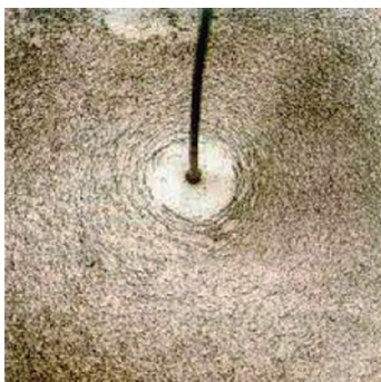
Fig. 4.63 La orientación de las limaduras de hierro en el campo magnético inherente a un conductor recto por el que circula corriente permite “visualizar” las líneas de inducción magnética
