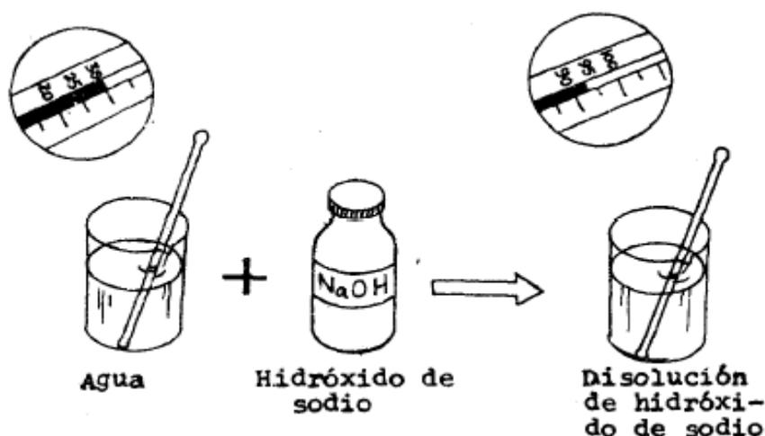
Figura 2.10: Proceso de disolución exotérmico.
