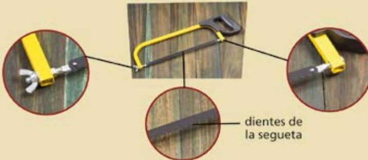
**Fig. 2.39** Colocación de la hoja de segueta
