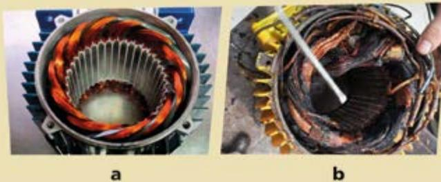
Fig. 3.57 Bobina de un motor eléctrico: a) en buen estado; b) quemada
