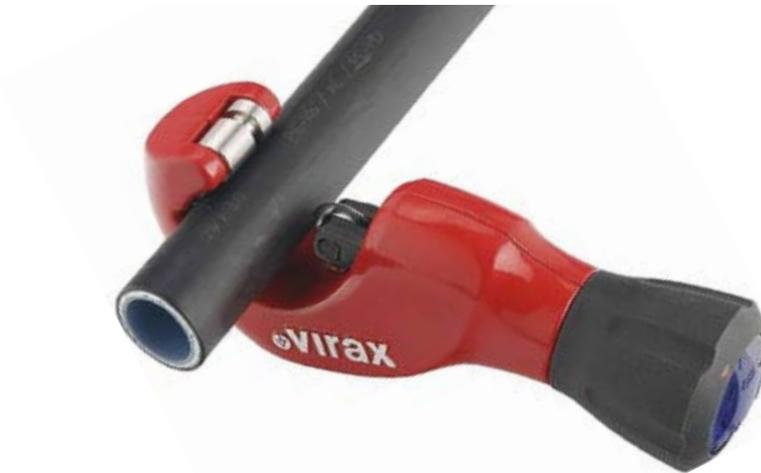
**Fig. 2.46** Corte con el cortatubo
