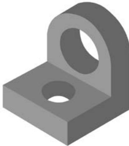
**Fig. 1.30** Pieza que contiene superficies curvas
