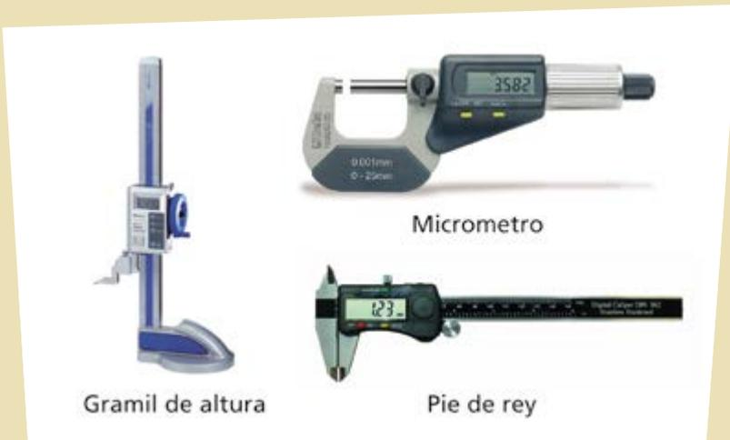
**Fig. 2.23** Otros instrumentos para medir, trazar y comprobar las dimensiones
