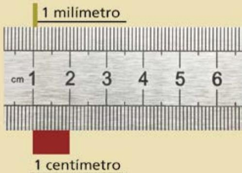
**Fig. 2.21** Graduación de la regla de medición
