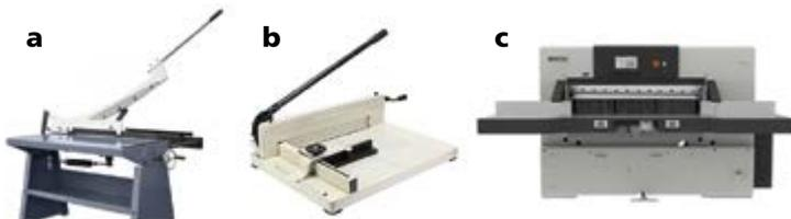
**Fig. 2.34** Diferentes tipos de guillotinas: a) manual para metales; b) manual para papel; c) industrial para papel
