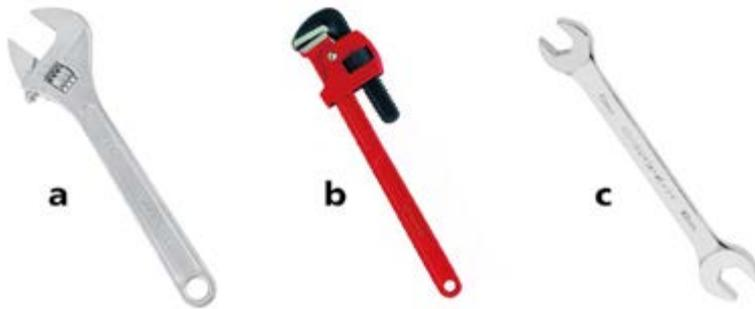
**Fig. 4.4** Llaves para el mantenimiento: a) ajustables; b) inglesa; c) españolas
