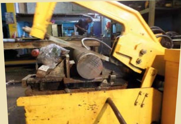
**Fig. 2.45** Aserrado mecánico de metal
