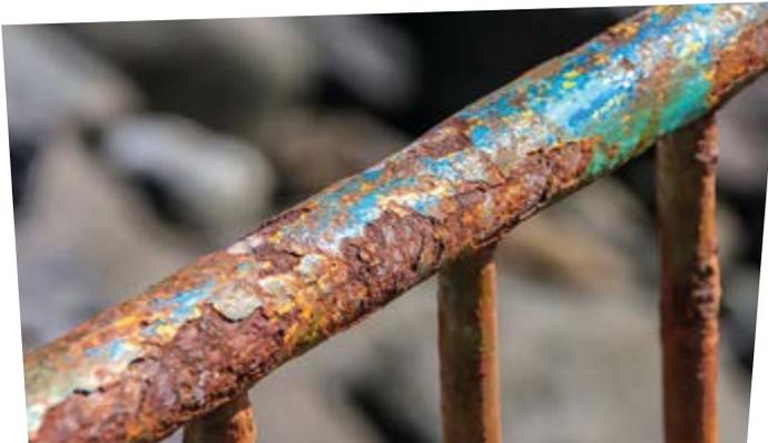
**Fig. 2.10** Corrosión de pieza metálica
