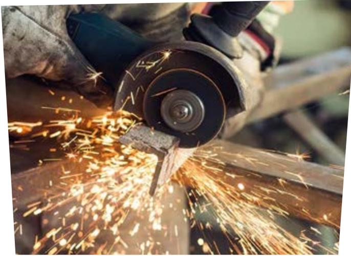
**Fig. 2.47** Corte o aserrado del metal con disco de corte
