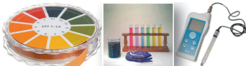
**Fig. 1.20** Indicadores y pH metro para la determinación experimental del pH
