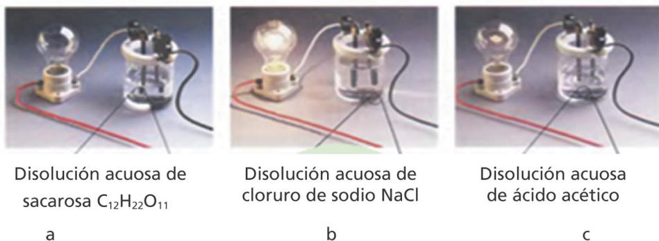
**Fig. 1.13** Medición de la conductividad eléctrica de diferentes disoluciones:
