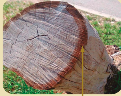
Parte enferma de la albura y la formación de grietas
