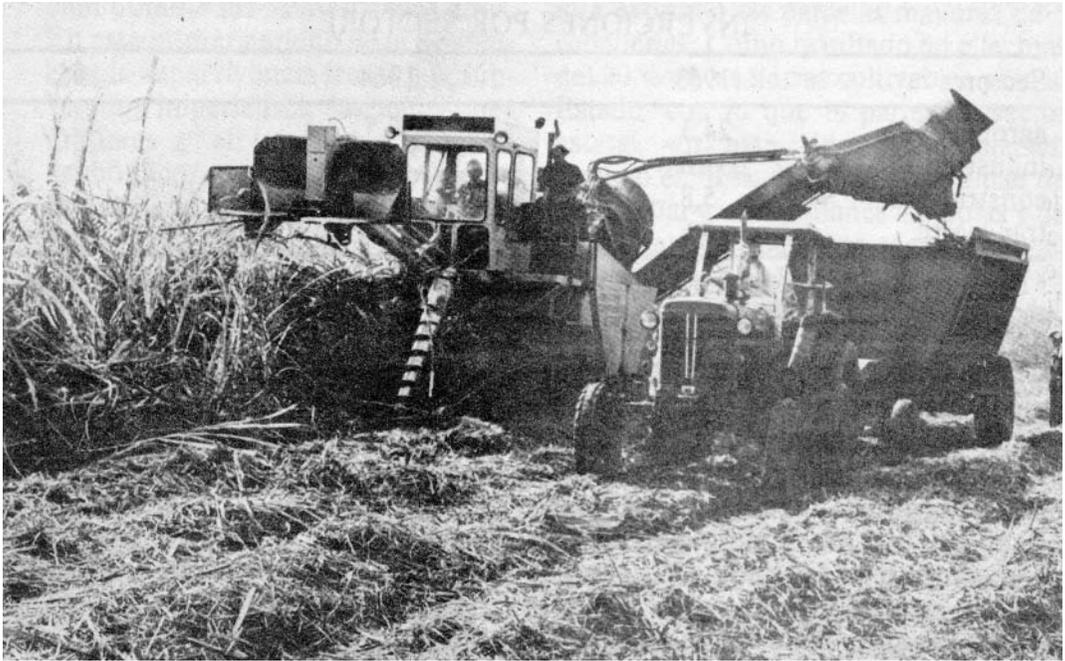
Fig. 9.6 Máquina cortadora de caña KTP-1.
