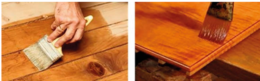
Fig. 6.29 Forma de aplicar la goma laca con brocha
