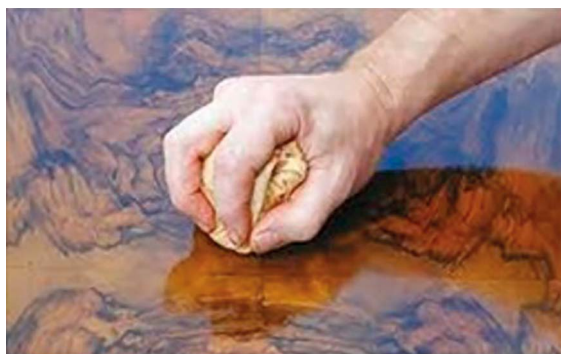
Fig. 6.30 Forma de aplicar la goma laca con la muñeca
