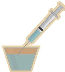
**Fig. 4.9** Dispositivo (jeringuilla) cuyo principio de funcionamiento se basa en la existencia de la presión atmosférica
