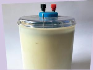
**Fig. 5.40** Calorímetro
