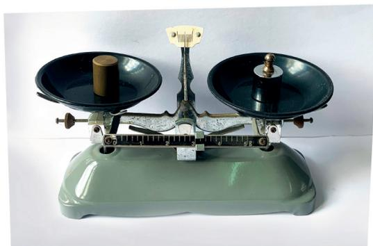
**Fig. 3.14** Balanza de dos platos
