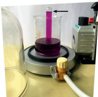
**Fig. 4.41** Experimento que ilustra lo que sucede al invertir un tubo de ensayo lleno de líquido coloreado y colocarlo en un recipiente que contiene líquido
