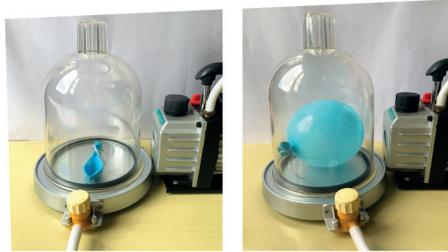
**Fig. 4.8** Experimento que demuestra los efectos de la presión que ejercen los gases sobre los cuerpos sumergidos en ellos
