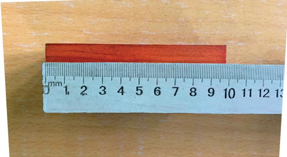
**Fig. 1.28** Bloque de madera al que se le va a determinar de forma indirecta el volumen, midiendo el largo, el ancho y el grosor de forma directa con la regla graduada
