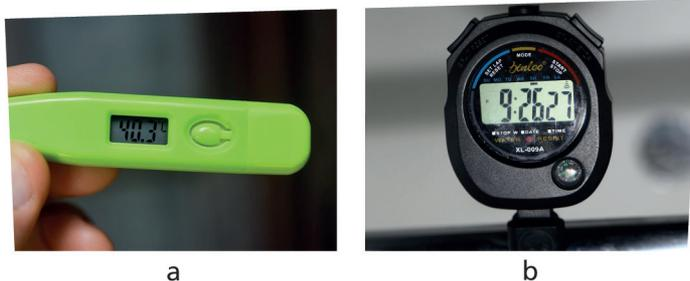
**Fig. 1.31** Instrumentos digitales: a) termómetro ; b) cronómetro
