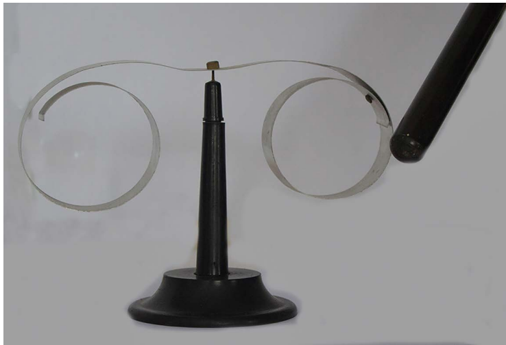
Fig. 2.19 Interacción entre una varilla electrizada y los aros metálicos
