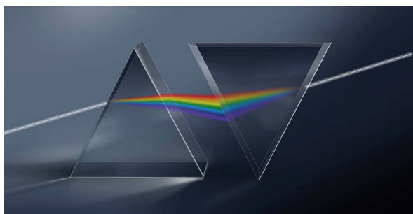
Fig. 4.31 Al colocar un segundo prisma en la trayectoria de los haces que emergen del primer prisma, se obtiene un único haz de luz blanca
