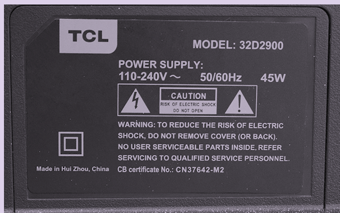
Fig. 2.72 Placa o etiqueta con los datos de un equipo eléctrico (TV panda)
