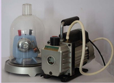
Fig. 1.56 Timbre que se pone a funcionar dentro de la campana de vacío, con o sin aire
