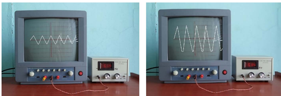
Fig. 1.66 Representación de las oscilaciones observadas en el osciloscopio de sonidos con diferente intensidad
