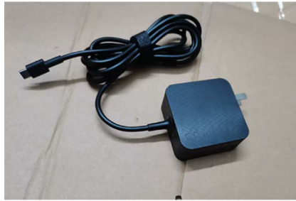
Fig. 3.63 Cargador de batería de una laptop (transformador reductor)
