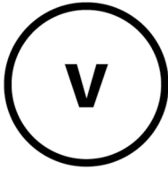
Fig. 2.85 Medición de la tensión eléctrica: a) símbolo del voltímetro; b) instrumentos que permiten medir la tensión de la corriente eléctrica
