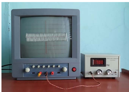
Fig. 1.67 Representación de las oscilaciones observadas en un osciloscopio al variar la frecuencia de la onda sonora
