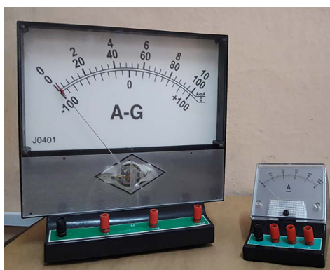
Fig. 2.77 Símbolos e instrumentos para medir la intensidad de corriente eléctrica: a) símbolo del amperímetro; b) instrumentos de medición de la intensidad de corriente eléctrica
