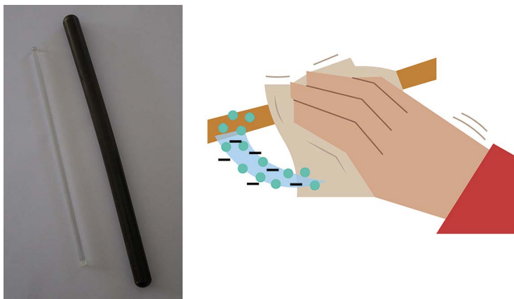
Fig. 2.8 a) Varilla de ebonita y agitador de vidrio; b) electrización por frotamiento
