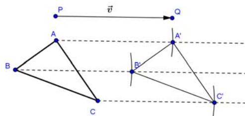
Luego dado el vector de traslación  $\vec{v}$  y un punto original, se construye su imagen trazando una semirrecta de origen en el punto original; paralela al vector de traslación y de igual sentido, se determina
